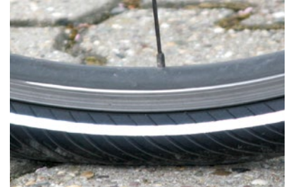
So sollte es aussehen. Der Reifen ist unter der Last des Fahrers kaum verformt.
