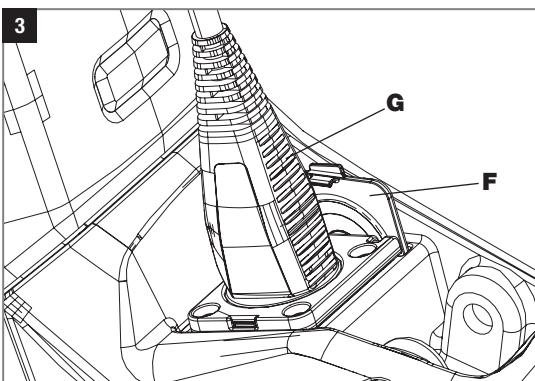
Die Ladebuchse ist somit zugänglich für den Ladestecker (G). Den Ladestecker (G) durch leichten Druck einschieben. **Die geriffelte Seite des Steckers muss in Richtung Hinterrad zeigen und die Seite mit der Vertiefung in Richtung Vorderrad.** Wie der Akku geladen wird, entnehmen Sie bitte dem Bosch-Handbuch „Bosch eBike Akku-Guide“.
