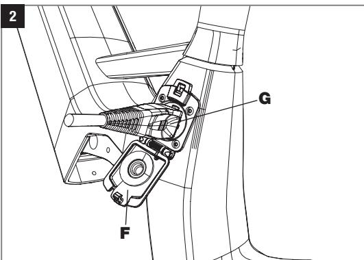
Die Ladebuchse ist somit zugänglich für den Ladestecker (G). Den Ladestecker (G) durch leichten Druck einschieben. **Die geriffelte Seite des Steckers muss in Richtung Vorderrad zeigen und die Seite mit der Vertiefung in Richtung Hinterrad.** Wie der Akku geladen wird, entnehmen Sie bitte dem Bosch-Handbuch „Bosch eBike Akku-Guide“.
