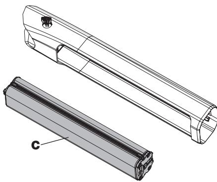
Der Akku (C) ist jetzt vollständig vom Rahmen getrennt und kann zum Beispiel zum Aufladen transportiert werden.
