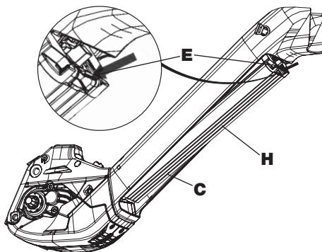
Durch das Öffnen des Schlosses löst sich der Akku (C) aus der oberen Fixierung. Sichern Sie weiterhin mit der Hand den Akku gegen versehentliches herunterfallen (H).
