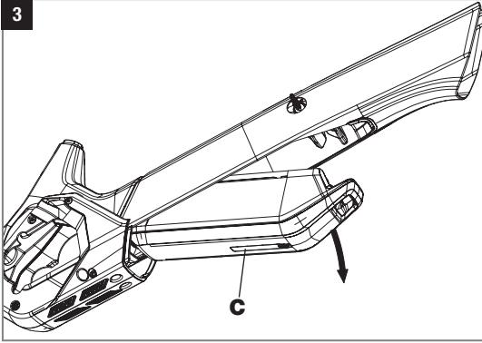
Kippen Sie jetzt den Akku (C) nach unten, bis er horizontal aus dem Unterrohr herausragt.
