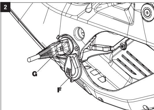
Die Ladebuchse ist somit zugänglich für den Ladestecker (G). Den Ladestecker (G) durch leichten Druck einschieben. **Die geriffelte Seite des Steckers muss in Richtung Vorderrad zeigen und die Seite mit der Vertiefung in Richtung Hinterrad.** Wie der Akku geladen wird, entnehmen Sie bitte dem Bosch-Handbuch „Bosch eBike Akku-Guide“ oder dem STEVENS Handbuch.
