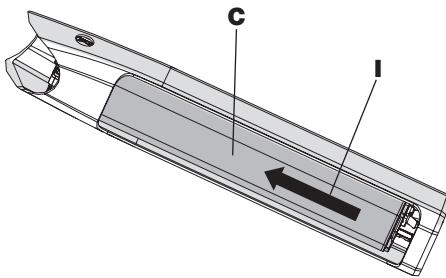
Zur vollständigen Fixierung des Akkus (C), schieben Sie den Akku in der jetzigen Position ein kleines Stück nach oben (I) bis Sie spüren das der Akku oben einrastet und vollständig fixiert ist. Der Akku hat jetzt die endgültige Position erreicht.
