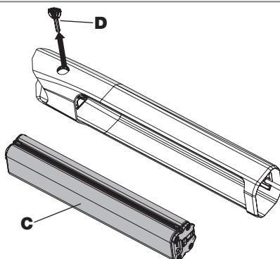
Zur Montage des Akkus (C) muss er vorher vollständig vom Ladegerät getrennt sein.
