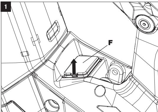
Die Abdeckung (F) auf der Oberseite des Motor-Interface durch Ziehen an der kleinen Lasche öffnen und nach oben aufklappen.
