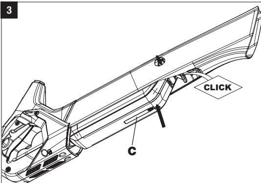
Zur vollständigen Fixierung des Akkus (C), wird Druck (nach oben) im Bereich der roten Haltesicherung mit Schloss auf den Akku ausgeübt. Es ertönt ein „CLICK“-Geräusch, sobald der Akku die endgültige Position erreicht hat.
