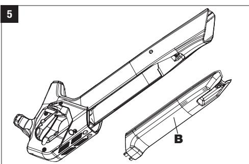
Drücken Sie den Knopf (A), um den Deckel (B) aus der Fixierung zu lösen. **2**
