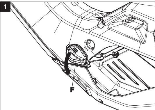
Die Abdeckung (F) an der linken Seite des Motor-Interface mit leichtem Druck von oben entriegeln und nach unten drehen um die Ladebuchse zugänglich zu machen.
