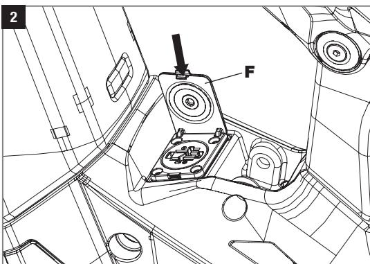
Die Abdeckung (F) mit leichtem Druck von oben nach unten schieben um einen besseren Zugang zur Ladebuchse zu gewährleisten.
