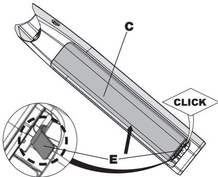
Führen Sie den Akku (C) in die untere Halterung bis ein „CLICK“-Geräusch der Ausfallsicherung (E) ertönt.
