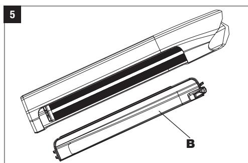
Schieben Sie die Verriegelung (A) nach unten, um den Deckel (B) aus der Fixierung zu lösen. **2**
