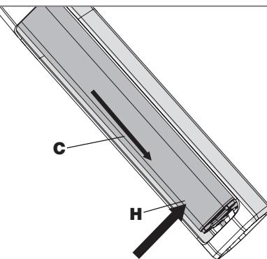
Durch das Öffnen des Schlosses löst sich der Akku (C) aus der oberen Fixierung und rutscht ein kleines Stück nach unten. Sichern Sie weiterhin mit der Hand den Akku gegen versehentliches herunterfallen (H).
