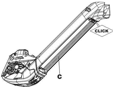
Zur vollständigen Fixierung des Akkus (C), wird Druck (nach oben) im Bereich der Haltesicherung mit Schloss auf den Akku ausgeübt. Es ertönt ein „CLICK“-Geräusch, sobald der Akku die endgültige Position erreicht hat.
