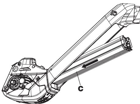
Zur Montage des Akkus (C) muss er vorher vollständig vom Ladegerät getrennt sein.
