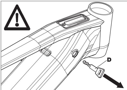
**Der Schlüssel (D) muss** unbedingt vor dem Pedalieren **entfernt werden**. Ansonsten kann der Schlüssel und/oder das Schloss beschädigt werden.
