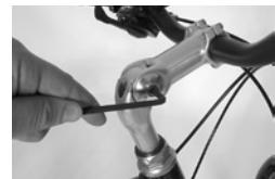
Sur les vélos STEVENS équipés d'un jeu de direction de type Aheadset®, la précontrainte du jeu de direction est ajustée à l'aide de la potence. Si la position de la potence est modifiée, le jeu de direction doit être rereglé.
