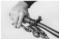
Bei hydraulischen Bremsen befinden sich ebenfalls Verstellvorrichtungen am Bremshebel. Es gibt unterschiedliche Systeme, fragen Sie Ihren STEVENS Fachhändler oder lesen Sie die Anleitungen der Komponentenhersteller.
