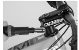
Bei STEVENS Fahrrädern mit Aheadset®-Lenkungslager wird mit Hilfe des Vorbaus die Lagervorspannung eingestellt. Wird die Vorbauposition verändert, muss das Lagerspiel neu justiert werden.
