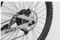
Kontrollieren Sie die Befestigung nach den ersten ein bis zwei Betriebsstunden und danach alle 20 Betriebsstunden.
