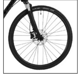
Das Laufrad ist aus der Nabe, den Speichen und der Felge aufgebaut. Auf die Felge wird der Reifen montiert, in den der Schlauch eingelegt ist. Zum Schutz des empfindlichen Schlauches wird ein Felgenband auf die Speichennippel und den oft scharfkantigen Felgenboden gelegt.
