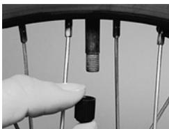
Lassen Sie sich vom STEVENS Fachhändler beraten. Oft wird der Druck in der englischen Einheit PSI (Pound per Square Inch) angegeben. In der Tabelle sind gängige Werte umgerechnet. Der Reifen allein ist mit der Felge nicht luftdicht. Um den Druck im Inneren zu halten, wird der Schlauch in den Reifen eingelegt. Er wird durch ein Ventil befüllt.
