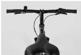
Klemmen Sie die Sattelstütze fest. Schließen Sie dazu entweder den Schnellspanner, wie im Kapitel „**Handhabung von Schnellspannern**“ beschrieben, oder drehen Sie die Sattelstützenklemmschraube in halben Umdrehungen im Uhrzeigersinn. Eine ausreichende Klemmwirkung sollten Sie bereits ohne Einsatz von großen Handkräften erreichen. Andernfalls passt die Sattelstütze nicht zum Rahmen.
