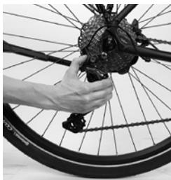
Bei **Hinterrädern mit Kettenschaltung** sollten Sie vor der Demontage vorne auf das mittlere bzw. kleine Kettenblatt und hinten auf das kleinste Ritzel schalten. So behindert das ganz außen stehende Schaltwerk den Radausbau nicht und die Kettenspannung ist nicht zu hoch.
