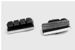
Halten Sie den Bereich des Bremsbelages in der hydraulischen Bremszange sauber, denn sonst kann der Belag nicht mehr vollständig in die Ruhestellung zurück gleiten. Überprüfen Sie gelegentlich die Leitungen und die Anschlüsse auf Dichtigkeit.
