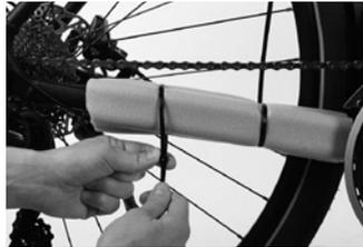
Fertigen Sie eine solide Auflage für das Tretlagergehäuse aus Karton oder hartem Schaumstoff, damit das Kettenblatt nicht aufsetzen kann oder Sie bekommen es bereits fertig von Ihrem Radhändler. Sie können auch zwei Auflagen für Gabel und das Ausfallende verwenden.
