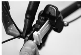
Drehen Sie die Kurbel parallel zur Kettenstrebene und fixieren Sie das Pedalauge mit Draht an der Kettenstrebene. Fixieren Sie auch die Kette an der Stelle wo diese auf das Kettenblatt aufläuft und dort wo sie dieses wieder verlässt. So kann die Kette nicht abfallen und Schäden anrichten und das kantige Kettenblatt ist etwas entschärft.
