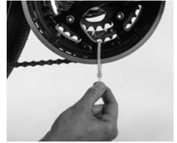
Halten Sie das Schaltwerk mit einer Hand fest, damit es durch die Federspannung nicht unkontrolliert abfällt, lösen Sie die Schraube und demontieren Sie es. Schützen Sie die Kettenstrebene entweder mit etwas Luftfolie oder mit Schaumstoffrohren z.B. von Warmwasserrohren. Binden Sie das Schaltwerk etwa mittig an die so geschützte Strebene.
