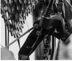
Korrigieren Sie die Position gegebenenfalls mit der Endanschlagschraube. Bei Schaltwerken sind die Schrauben oft mit „H“ für „high gear“, und „L“ für „low gear“ gekennzeichnet. Der hohe Gang bedeutet in diesem Fall die große Übersetzung, also das kleine Ritzel.
