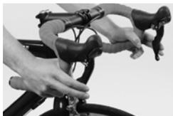
Bei einigen Modellen verschiedener Hersteller ist dies am Brems-/Schalthebel möglich, z.B. durch Einstellschrauben oder sogenannte Distanzstücke. Bei den anderen werden die Seilzüge an den Bremskörpern entsprechend geklemmt. Dort befindliche Stellschrauben dienen lediglich dem Ausgleich des auftretenden Bremsbelagverschleißes.
