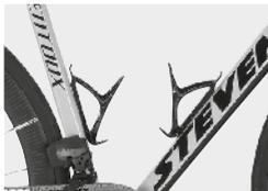
Halten Sie sich an ein Drehmoment von 2–3 Nm. Überschreiten Sie das maximale Drehmoment von 3 Nm keinesfalls.
