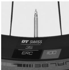
Lassen Sie sich vom STEVENS Fachhändler beraten. Oft wird der Druck in der englischen Einheit PSI (Pound per Square Inch) angegeben. In der Tabelle sind gängige Werte umgerechnet. Der Reifen allein ist mit der Felge nicht luftdicht. Um den Druck im Inneren zu halten, wird der Schlauch in den Reifen eingelegt. Er wird durch ein Ventil befüllt.
