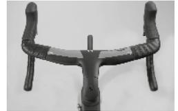
Einige Modelle sind mit integrierten Zügen ausgestattet. Dies bedeutet, dass Bremsleitungen, Schaltzügen bzw. -kabel in der Lenker-Vorbau-Kombination, im Rahmen und ggf. auch in der Gabel verlaufen.
