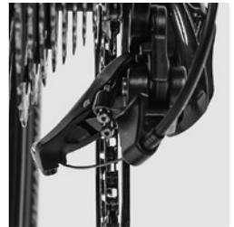
Schalten Sie mit dem rechten Schalthebel auf den größten Gang. Der Schaltzug ist dann völlig entspannt, die Kette läuft auf dem kleinsten Ritzel. Schauen Sie von hinten aufs Zahnkranzpaket und prüfen Sie, ob die Leitrolle des Schaltwerkes genau unter den Zahnspitzen des Ritzels liegt.
