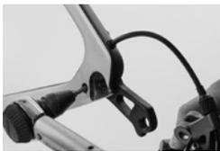
Kleben Sie die Schrauben mit mittelfestem Schraubenkleber (mit Werkzeug lösbar) ein und halten Sie sich an ein Drehmoment von 2–3 Nm. Überschreiten Sie das maximale Drehmoment von 3 Nm keinesfalls.
