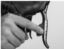
Bei **SRAM AXS**, d.h. den elektronischen Brems-/Schaltgriffen, führt ein Betätigen des rechten Schalthebels dazu, dass das hintere Schaltwerk die Kette nach außen hin, d.h. zu den kleineren Ritzeln bzw. größeren Gängen, bewegt. Drückt man dagegen den linken Schalthebel, schaltet das Schaltwerk zu den größeren Ritzeln.
