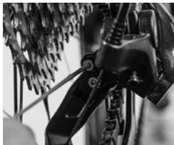
Bei nicht markierten Schrauben hilft nur der Versuch. Drehen Sie an einer Schraube, zählen Sie die Umdrehungen mit und beobachten Sie das Schaltwerk. Bewegt es sich nicht, drehen Sie gerade an der Schraube für den anderen Anschlag. Drehen Sie die Anzahl der Umdrehungen zurück.
