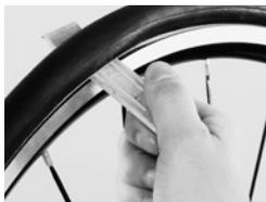
Der Ersatz eines einzelnen Schlauches ist nicht möglich, stattdessen müssen Sie einen kompletten Schlauchreifen auf die Felge ziehen. Unterwegs kann der Reifen nicht geklebt werden und sitzt daher auch nach dem Aufpumpen nicht sicher auf der Felge.
