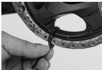
Drehen Sie die Kurbel parallel zur Kettenstrebe und fixieren Sie das Pedalauge mit Draht an der Kettenstrebe. Fixieren Sie auch die Kette an der Stelle wo diese auf das Kettenblatt aufläuft und dort wo sie dieses wieder verlässt. So kann die Kette nicht abfallen und Schäden anrichten und das kantige Kettenblatt ist etwas entschärft.
