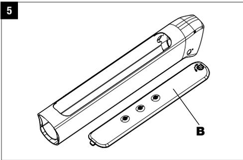
Drehen Sie den Verschluss (A) gegen den Uhrzeigersinn. Der Deckel (B) löst sich so aus der Fixierung. **2**
