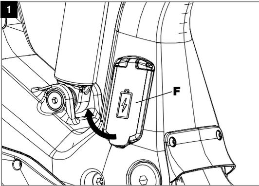
Die Abdeckung (F) an der linken Seite des Sitzrohres über dem Motor-Interface von unten mit leichtem Druck entriegeln, leicht anheben und vorsichtig nach oben aufklappen.
