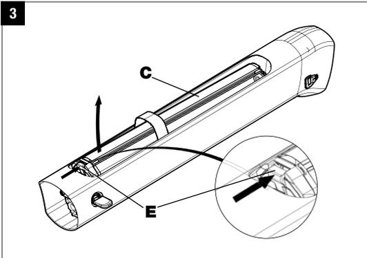
Zunächst muss per Finger die Rückhaltesicherung (E) entriegelt werden. Hierzu diese in Pfeil-Richtung drücken. Danach kann der Akku (C) komplett herausgenommen werden.
