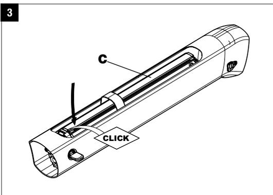
Zur vollständigen Fixierung des Akkus (C), wird Druck (nach unten) im Bereich der Halterung mit Schloss auf den Akku ausgeübt. Es ertönt ein „CLICK“-Geräusch, sobald der Akku die endgültige Position erreicht hat.
