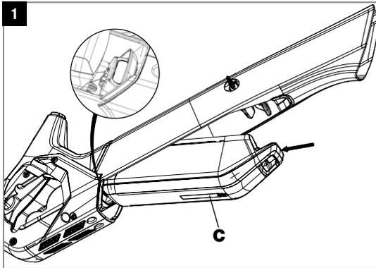
Zur Montage des Akkus (C) muss er vorher vollständig vom Ladegerät getrennt sein.
