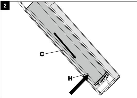
Durch das Öffnen des Schlosses löst sich der Akku (C) aus der oberen Fixierung und rutscht ein kleines Stück nach unten. Sichern Sie weiterhin mit der Hand den Akku gegen versehentliches Herunterfallen (H).
