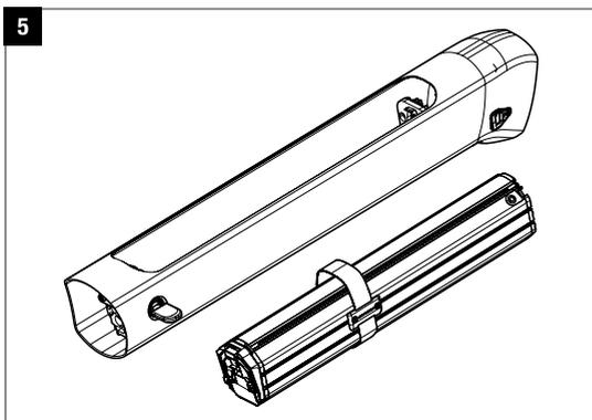
Der Akku ist jetzt vollständig vom Rahmen getrennt und kann zum Beispiel zum Aufladen transportiert werden.
