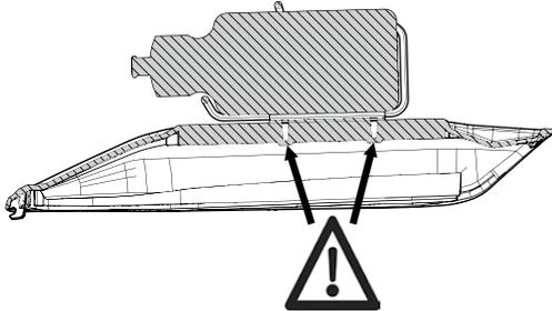
Die Gewinde für den Flaschenhalter oder Zubehör sind **nicht durchgängig**, eine Schraube kann **nur bis zu einer bestimmten Tiefe** eingeschraubt werden. Es handelt sich bei den Gewinden im Deckel um M5 Gewinde. Wird die Schraube zu weit eingeschraubt oder zu fest (MAX. 5 Nm) angezogen, kann es zu Schäden am Deckel, dem Gewinde oder sogar dem Akku kommen. Zur Auswahl der richtigen Schrauben wenden Sie sich bitte an Ihren STEVENS Fachhändler.
