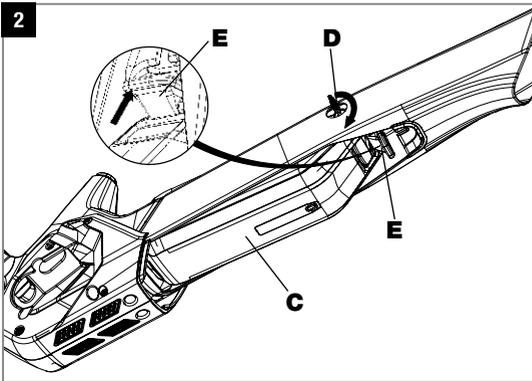
Als nächsten Schritt stecken Sie den Schlüssel in das Schloss und drehen ihn im Uhrzeigersinn, um das Schloss zu öffnen (D).
