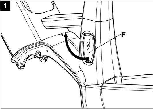
Die Abdeckung (F) an der linken Seite des Sitzrohres über dem Motor-Interface von unten leicht anheben und vorsichtig nach oben aufklappen.
