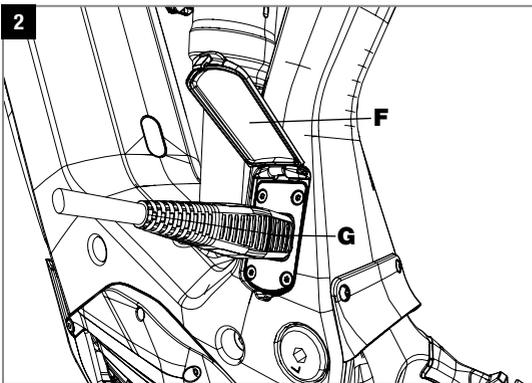
Die Ladebuchse ist somit zugänglich für den Ladestecker (G). Den Ladestecker (G) durch leichten Druck einschieben. Die geriffelte Seite des Steckers muss in Richtung Hinterrad zeigen und die Seite mit der Vertiefung in Richtung Vorderrad. Wie der Akku geladen wird, entnehmen Sie bitte dem Bosch-Handbuch „Bosch eBike Akku-Guide“ oder dem STEVENS Handbuch.
