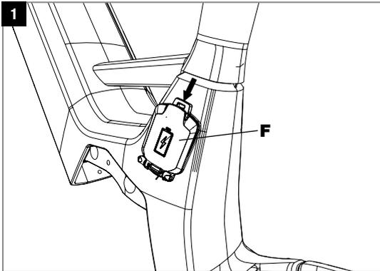
Die Abdeckung (F) an der linken Seite des Sitzrohres über dem Motor-Interface durch drücken der Verriegelung öffnen und nach unten aufklappen.
