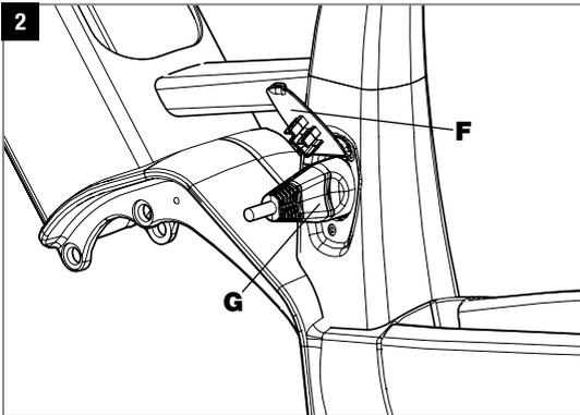
Die Ladebuchse ist somit zugänglich für den Ladestecker (H). Den Ladestecker (H) durch leichten Druck einschieben. Die geriffelte Seite des Steckers muss in Richtung Vorderrad zeigen und die Seite mit der Vertiefung in Richtung Hinterrad. Wie der Akku geladen wird, entnehmen Sie bitte dem Bosch-Handbuch „Bosch eBike Akku-Guide“.
