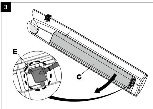
Drücken Sie die Haltesicherung (E) in Richtung des Motors, um den Akku (C) von der Halterung zu lösen. Halten Sie den Akku mit beiden Händen fest, damit er nicht nach unten herausfallen kann.
