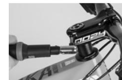
En bicicletas STEVENS equipadas con un sistema de dirección Aheadset®, la precarga del juego de dirección viene dada por la potencia. Si se cambia la posición de la potencia será necesario reajustar también el juego de dirección.
