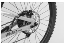
Compruebe la fijación segura después de una o dos horas de uso y, en adelante, cada 20 horas de uso.
